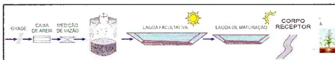
Figura 98 – Fluxograma típico de um sistema de tratamento com reatores UASB seguidos por sistema de lagoas
