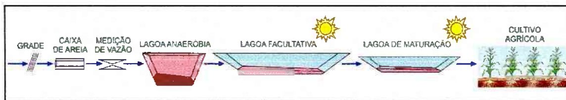
Figura 96 – Esquema de ETE composta por lagoa de estabilização
